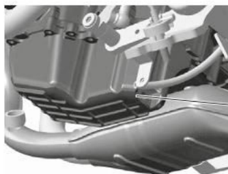
Vite di drenaggio
