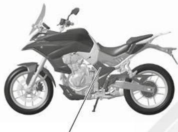
Vano portafusibili dietro fianchetto laterale sinistro
